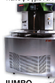
FBM - JUMBO Στρωτήρας σοκολάτας με σύστημα επικάλυψης και αποσπώμενου κοχλία. Η μεγαλύτερη επικαλυπτική μηχανή και στρωτήρας της Ευρώπης. Ταινία από 40 έως 60 cm. Παραγωγή 400 kg σοκολάτα την ώρα.
