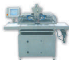
HACOS Μηχανή παραγωγής σοκολατινών με ένα χτύπημα.
