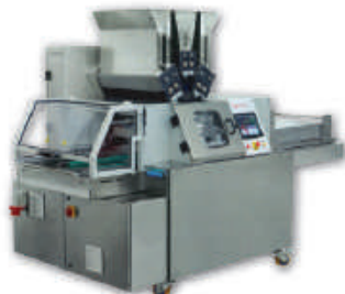
PADOVANI Μηχανή Παραγωγής βουτυμάτων γεμιστών, snacks γεμιστών και γλυκών του κιλού γεμιστών.
